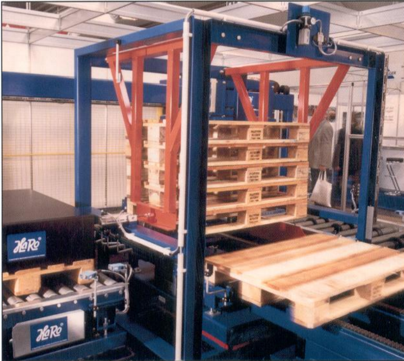
Stapel-Magazin (Euro-Palette) mit pneumatischen Haltearmen
