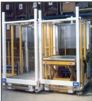
Stapel-Magazin für Spezial-Gitterboxen mit pneumatischen Haltearmen und Hubtisch
