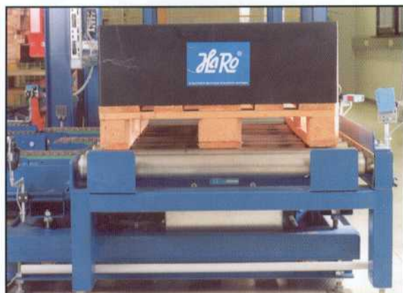
Paletten werden von Rollenbahn auf Kettenförderer umgesetzt.
