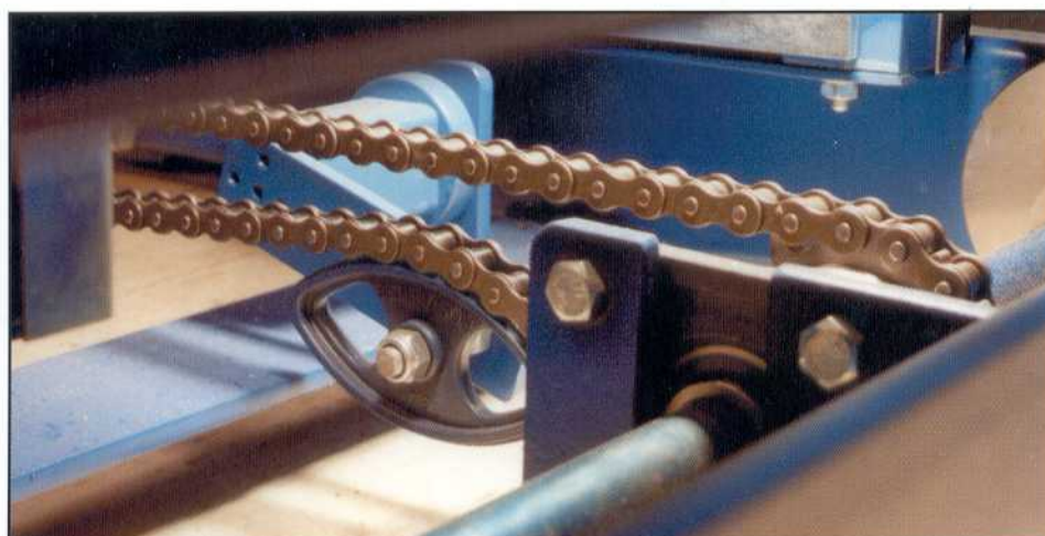
Die Kettenspannung erfolgt durch wartungsfreie Permanentspanner.
