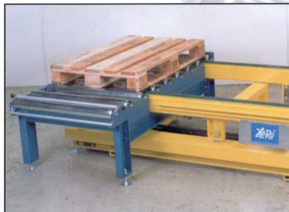
Durch den Exzenterheber wird der Kettenförderer angehoben und abgesenkt
