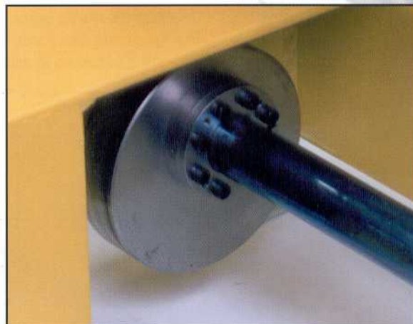
Exzentrerscheibe mit Spannelement und Welle
